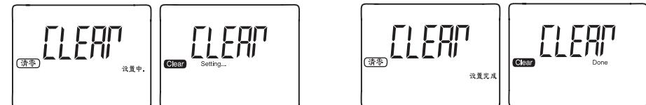
清零，即将总量强制置零。选择此项后，系统会自动开始设置，此时请不要按任何按键，约3秒后屏幕显示“设置完成”。随后，仪表会自动返回菜单选择。界面如左图。
