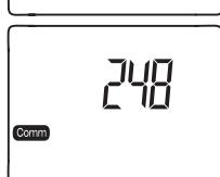
3位数字输入完成后，仪表开始进行内部参数设置。此时请不要按任何按键，约3秒后屏幕显示“设置完成”。随后，仪表会自动返回菜单选择。
